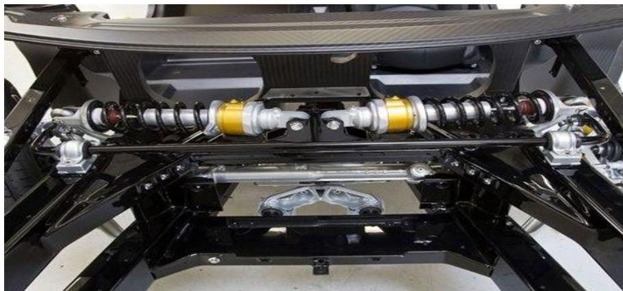
Если вы хотя бы раз пробовали раскачать перед автомобиля с вышедшими из строя передними амортизаторами, то могли заметить, что передок авто непрерывно скачет вверх-вниз. Если же амортизаторы исправны, то они остановят эти скачки в один ход, а жидкость в амортизаторе, перетекая, издаст шипящий звук.
